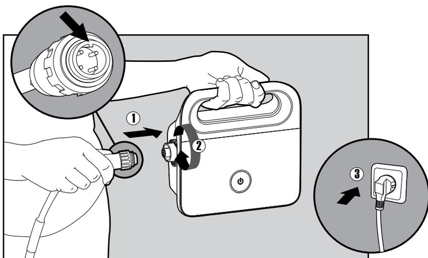
**5.1.3** Collegare il cavo flottante all'alimentatore inserendolo con la tacca sul connettore (1) allineata con la scanalatura nella presa sull'alimentatore, e girare in senso orario (2). Collegare l'alimentatore e lasciarlo in posizione OFF (3).
