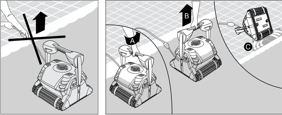
Use el cable flotador para acercar el limpiador hasta el borde de la piscina.
