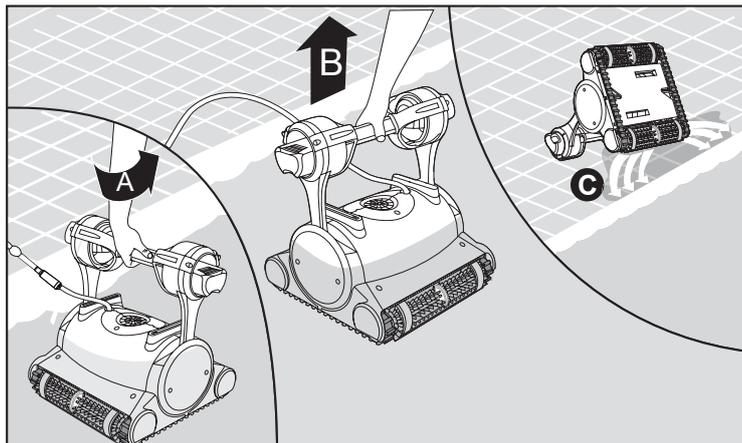
A l'aide du câble de flottaison, ramenez le nettoyeur de piscine au bord de la piscine.
