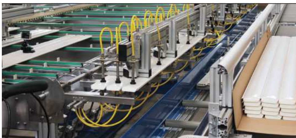
Machine automatique de confection des tabliers
