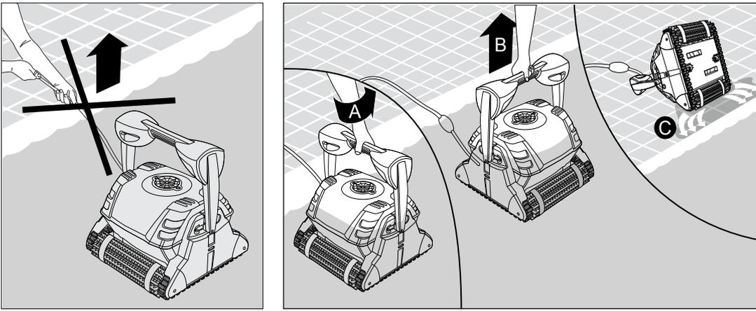
Ziehen Sie den Poolreiniger am Schwimmkabel zum Poolrand.
