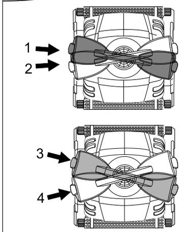
Ändern Sie die Position der Griffs für die Seitwärtsbewegung des Roboters entlang der Wasserlinie.
