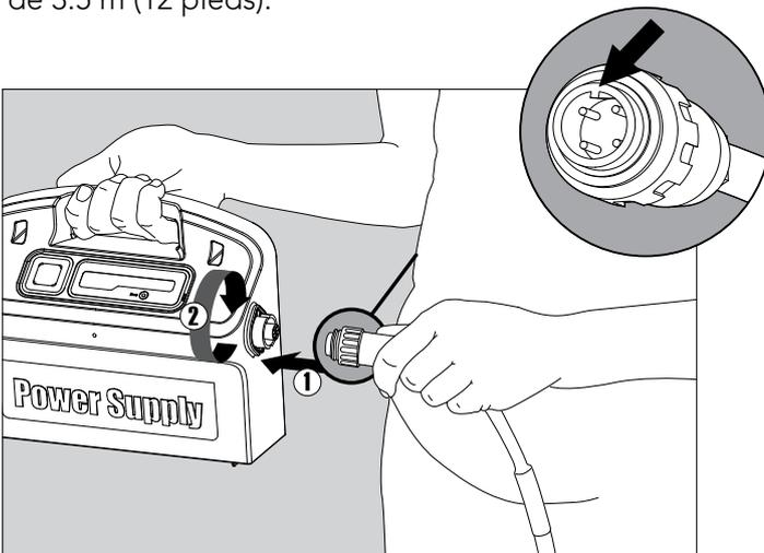
Branchez le câble flottant à l'alimentation en introduisez-le à l'aide de l'encoche dans le connecteur (1) et alignez-le avec la rainure de la prise du bloc d'alimentation; ensuite, tournez dans le sens des aiguilles d'une montre (2).
