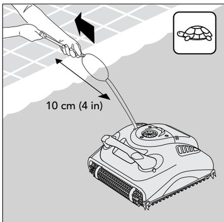
A l'aide du câble de flottaison, ramenez le nettoyeur de piscine au bord de la piscine.
