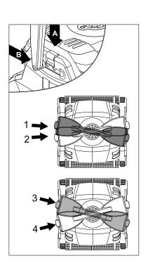
Modifiez la positione diagonale de la poignée pour que le robot effectue les mouvements latéraux nécessaires au nettoyage de la bordure de l'eau. Pour ajuster l'angle du manche:
