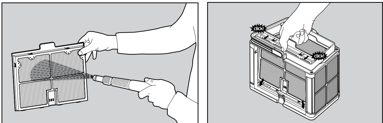
6.2.2 Промойте стенки фильтра водой из шланга.
