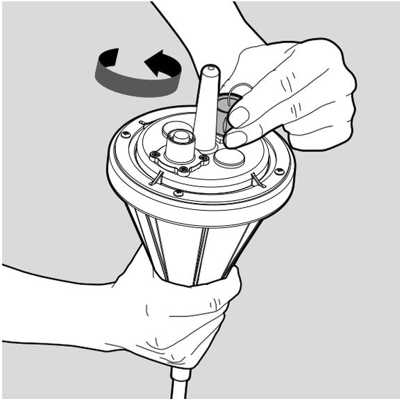
Abra la cubierta de la toma de carga en el flotador.
