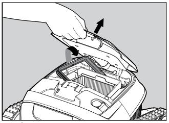
Beim Öffnen des Filterdeckels hebt sich der Griff selbstständig an.
