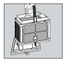
Öffnen Sie die Verriegelung, um den Bodendeckel zu entriegeln und Ablagerungen zu entfernen.
