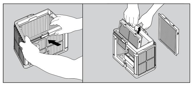
Demontieren Sie die zwei Platten mit den Daumen.
