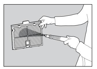
Reinigen Sie die Filterplatten mit einem Schlauch.
