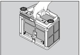
Montieren Sie die Filterplatten.
