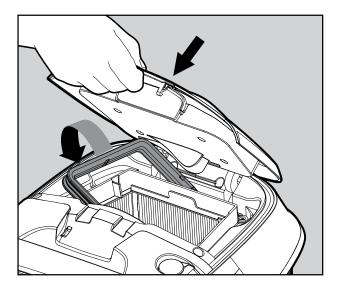
Setzen Sie den sauberen Filterkorb ein und schließen Sie den Filterdeckel.
