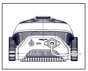
1. Schließen Sie das Ladegerät an den Roboter an.
