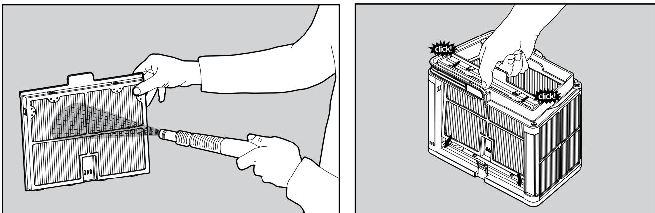
6.2.2 Промойте стенки фильтра водой из шланга.
