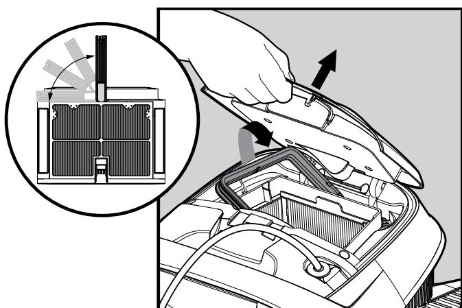
6.1.2 При открытии крышки фильтра, ручка автоматически поднимается.
