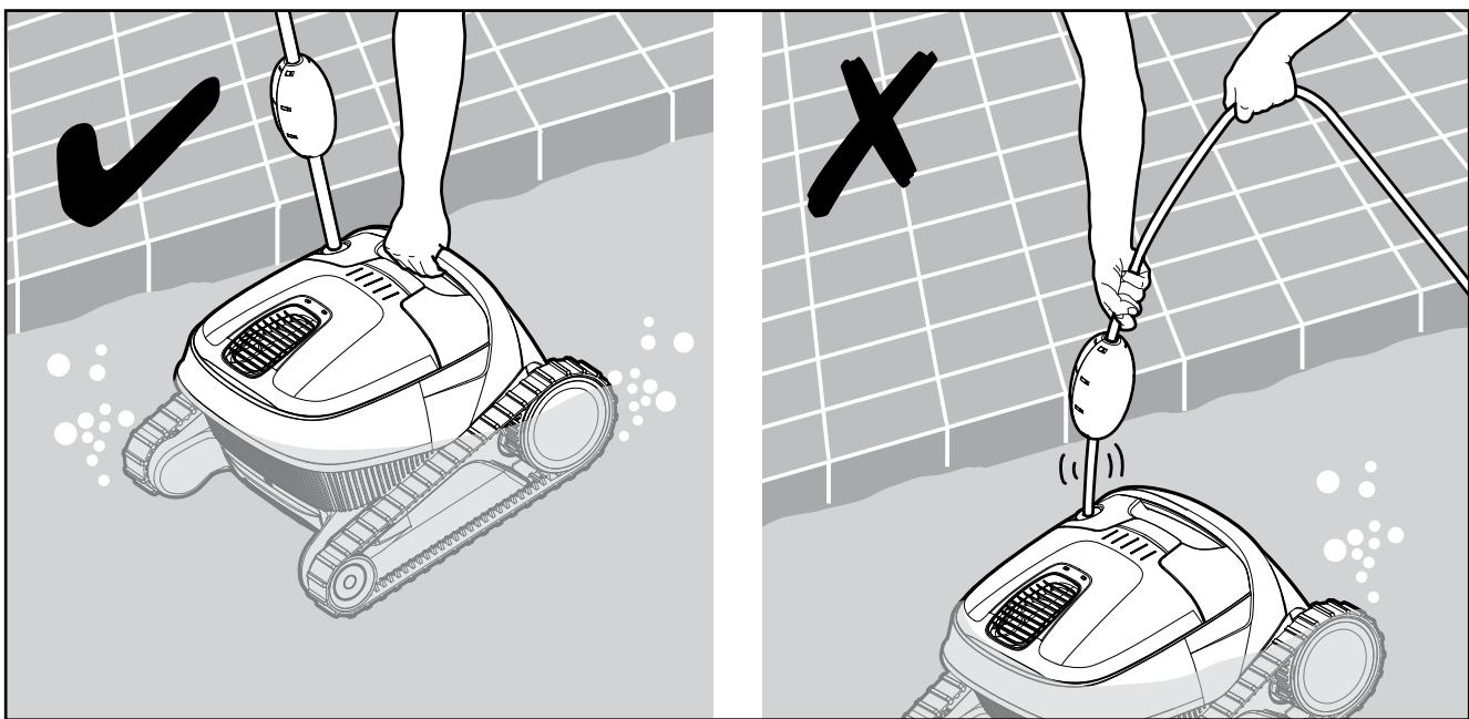
5.3.2 Используя плавающий кабель, притяните Робот для чистки бассейна к краю бассейна. Вытащите Робот из бассейна, держась за специальную ручку.
