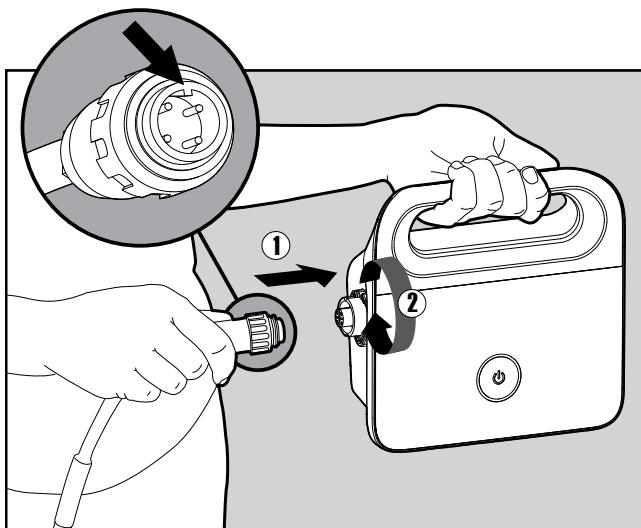
5.1.3 Подключите плавающий кабель к блоку питания, вставив штырь разъема кабеля (1), расположенного по одной линии с гнездом блока питания и поверните штырь по часовой стрелке (2).
