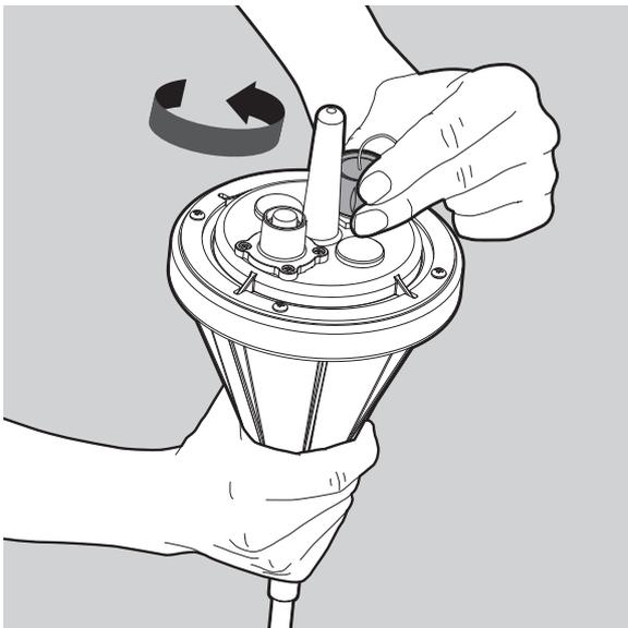
Öffnen Sie die Abdeckung der Ladebuchse am Schwimmer.
