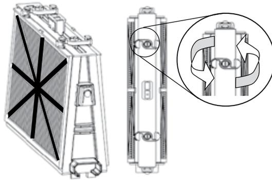
Re-installare i filtri secondo il diagramma
