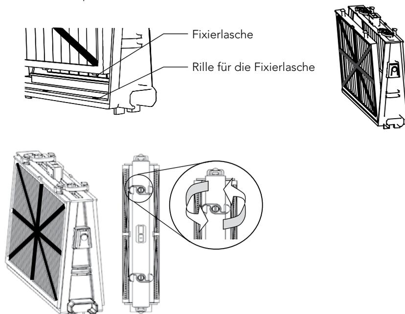
Setzen Sie die Filter gemäss das Diagramms wieder ein.
