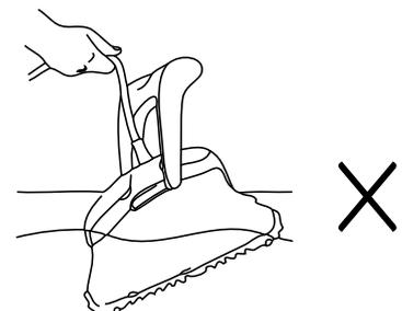
**Wichtig:** Ziehen Sie den Schwimmbad-Reinigungsroboter nicht mit Hilfe des Schwimmkabels aus dem Wasser.
