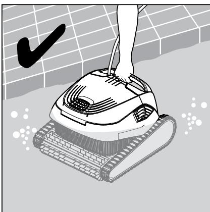
5.4.2 Используя плавающий кабель, притяните Робот для чистки бассейна к краю бассейна. Вытащите Робот из бассейна, держась за специальную ручку.
