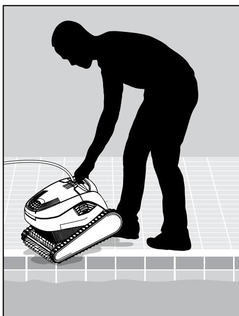
5.4.3 Поместите Робот для чистки бассейна на край бассейна и обеспечьте возможность слива воды из робота.
