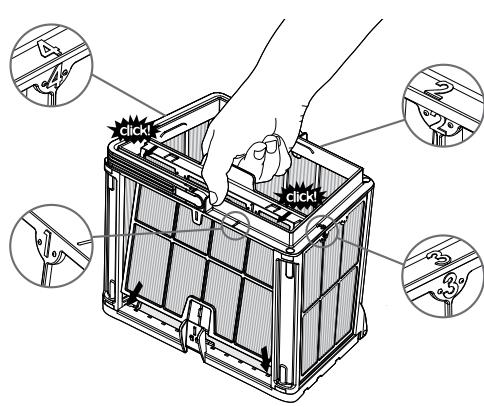
**6.2.5** Соберите стенки фильтра в соответствии со следующим порядком: Стенка 4 —> 3 —> 2 —> 1.
